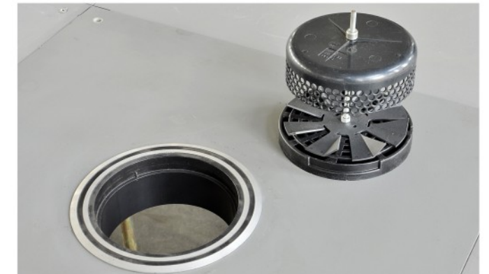
注：UFD-M-C-A散流器高度170mm，外框直径200mm，地板需要开孔圆直径170mm。 UFD-M-C-A diffuser height 170mm, frame diameter 200mm. The floor requires opening round diameter 170 mm.
